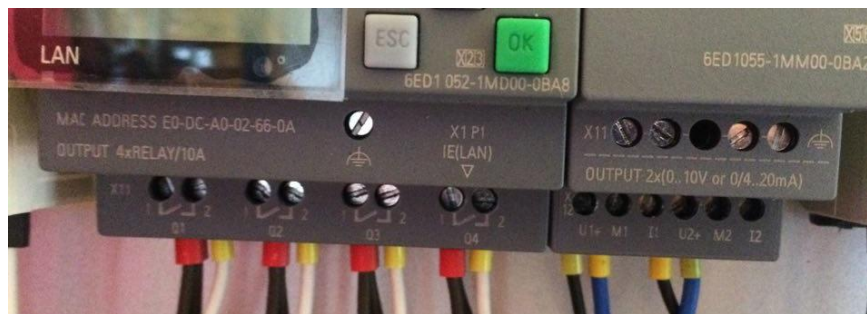
Figura 14-3 Conexión de salidas del relé programable
