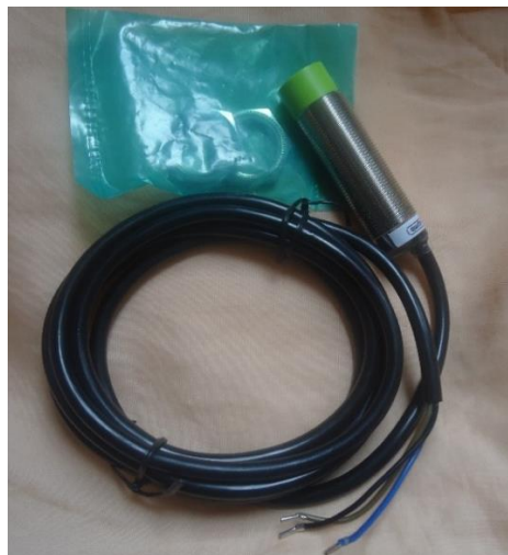
Figura 6-3 Sensor inductivo IM18-D1PA08 Fuente Xavier Yuquilema; Jhonny Rodríguez (2019)
