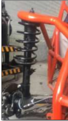
Figura 70-3: Amortiguador-muelle del Aveo family 1.5L
