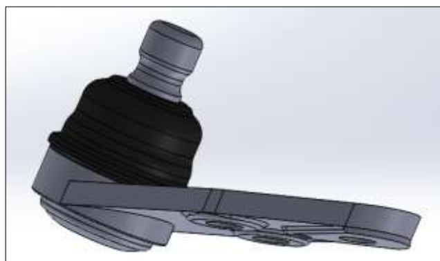
Figura 37-3: Geometría de la rótula de la suspensión delantera
