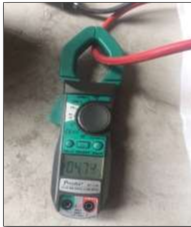
Figura 75-3: Consumo de corriente en la salida
