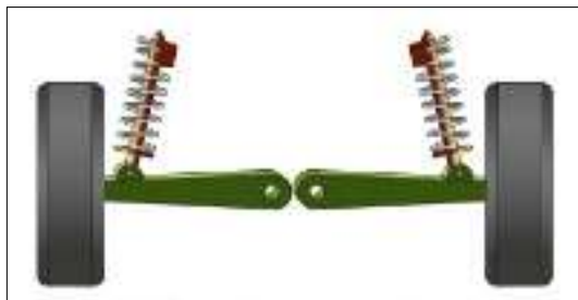
Figura 25-2: Eje oscilante de dos articulaciones
