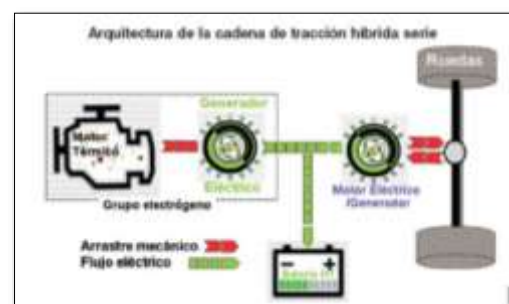
Figura 3-2: Cadena de tracción híbrida serie
