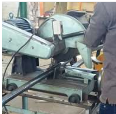
Figura 61-3: Corte de tubos
