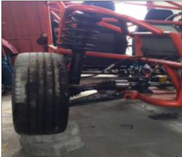
Figura 78-3: suspensión derecha elevado a 300 mm
