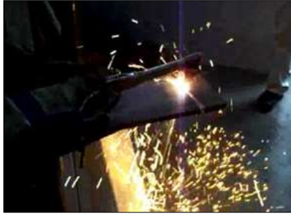
Figura 62-3: Corte con oxiacetileno
