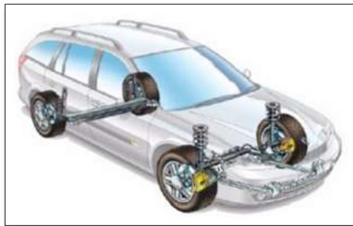
Figura 11-2: Sistema de suspensión vehicular
