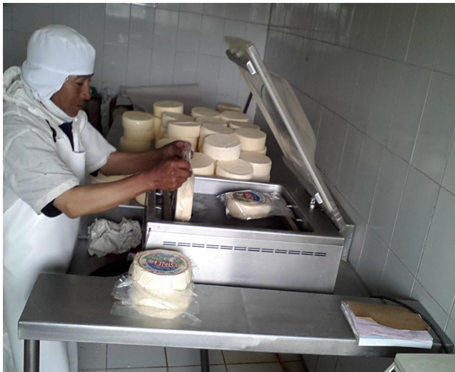
Figura 60-11: Área de empackado, empackador y empackadora al vacío Realizado por: Miguel Romero. 2018
