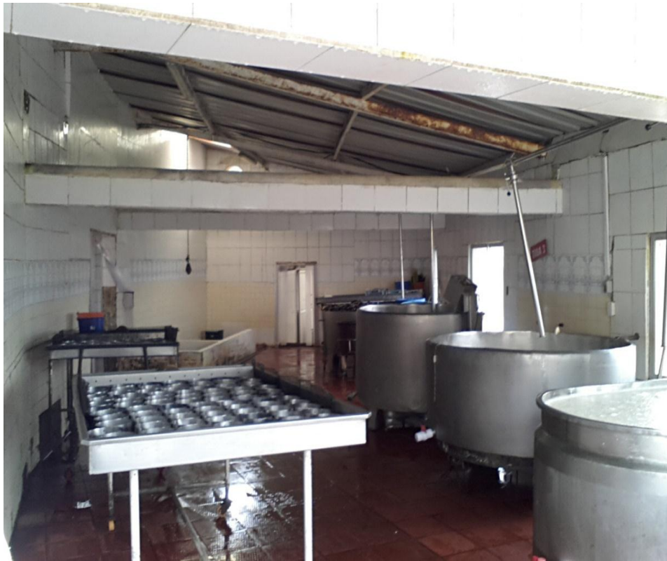
Figura 19-11: Área de procesamiento, transformación de la leche en queso Realizado por: Miguel Romero. 2018
