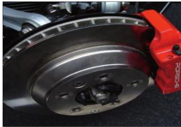
Figura 10-3: Discos de frenos ventilados Fuente: (LUQUE, y otros, 2008 pág. 173)
