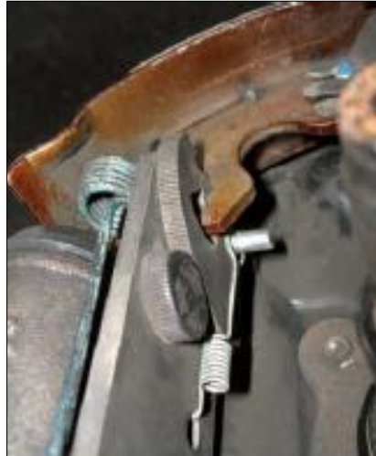
Figura 8-2: Sistema de reglaje por sector dentado Fuente: (Borja, y otros, 2009)
