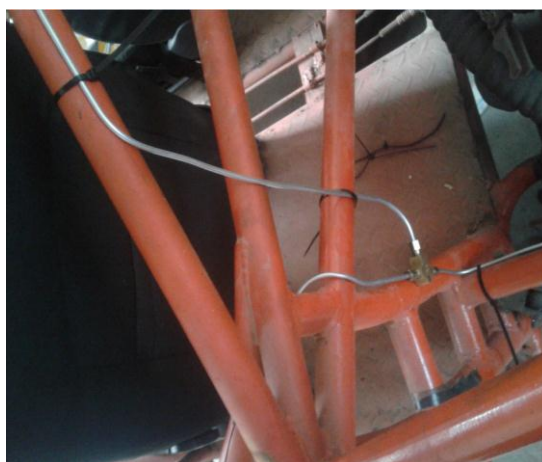
Figura 6-4: Dobles de cañerías
