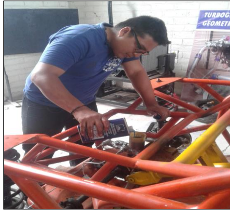
Figura 15-4: Colocación líquido de freno DOT3 Fuente: Autores
