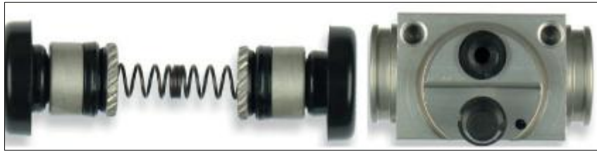
Figura 6-2: Actuador hidráulico Fuente: (CASADO, y otros, 2011 pág. 230)
