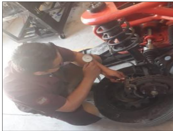
Figura 8-5: Prueba de presión en la mordaza delantera Fuente: Autores
