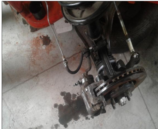
Figura 16-4: Purgado del sistema de freno Fuente: Autores
