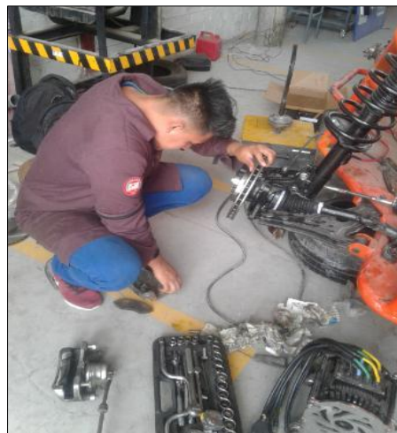
Figura 8-4: colocación de discos y cáliper Fuente: Autores
