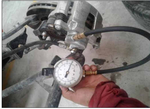
Figura 7-5: Prueba de presión en la mordaza trasera Fuente: Autores
