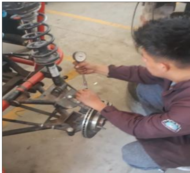
Figura 5-5: Prueba de presión del sistema en la mordaza trasera Fuente: Autores.
