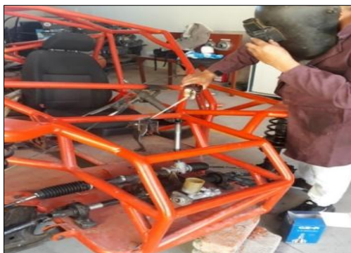
Figura 2-4: soldadura del pedal de freno
