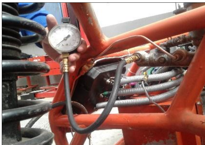
Figura 6-5: Prueba de presión general en la bomba
