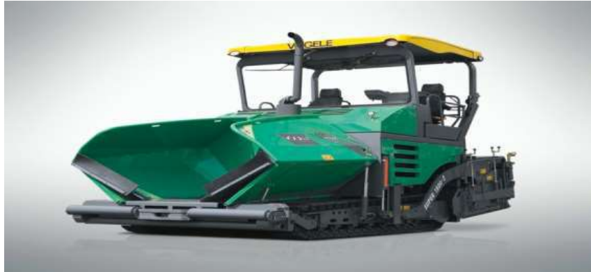
Figura 5: Terminadora de Asfalto SUPERIOR 1800-1, Marca GOGELE AG.
