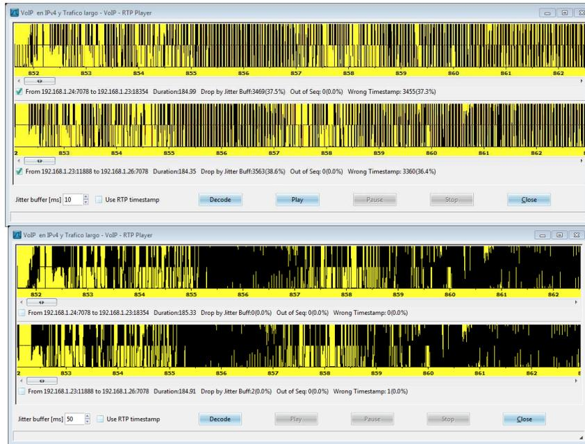
**Figura 6.8: Capturas de Audio con diferentes jitter buffer**
