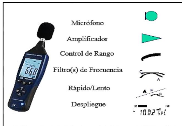
Figura 2-1: Componentes de un sonómetro Realizado por: Martínez Carolina, 2019
