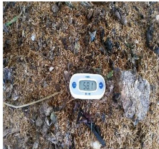
Medición de temperatura de la pila 2
