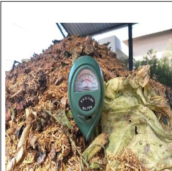
Medición de humedad de la pila 1
