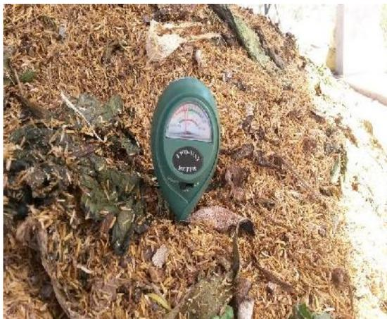
Medición de humedad de la pila 2
