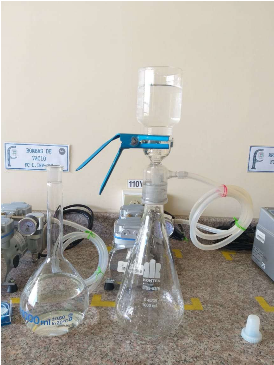
EQUIPO DE FILTRACIÓN
