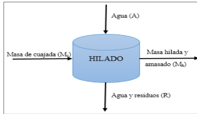
Figura 5-3: Balance de masa en la etapa de hilado Realizado por: Vicente Galindo, 2019.
