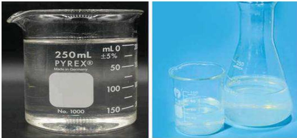
**Figura 3-2:** Formación de sílice coloidal a partir de silicato de sodio líquido
