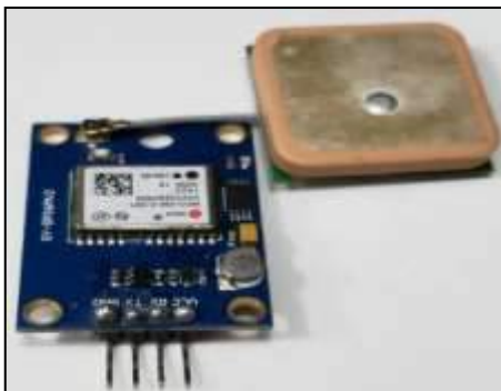
Figura 19-2: Aspecto Físico NEO-6M GPS
