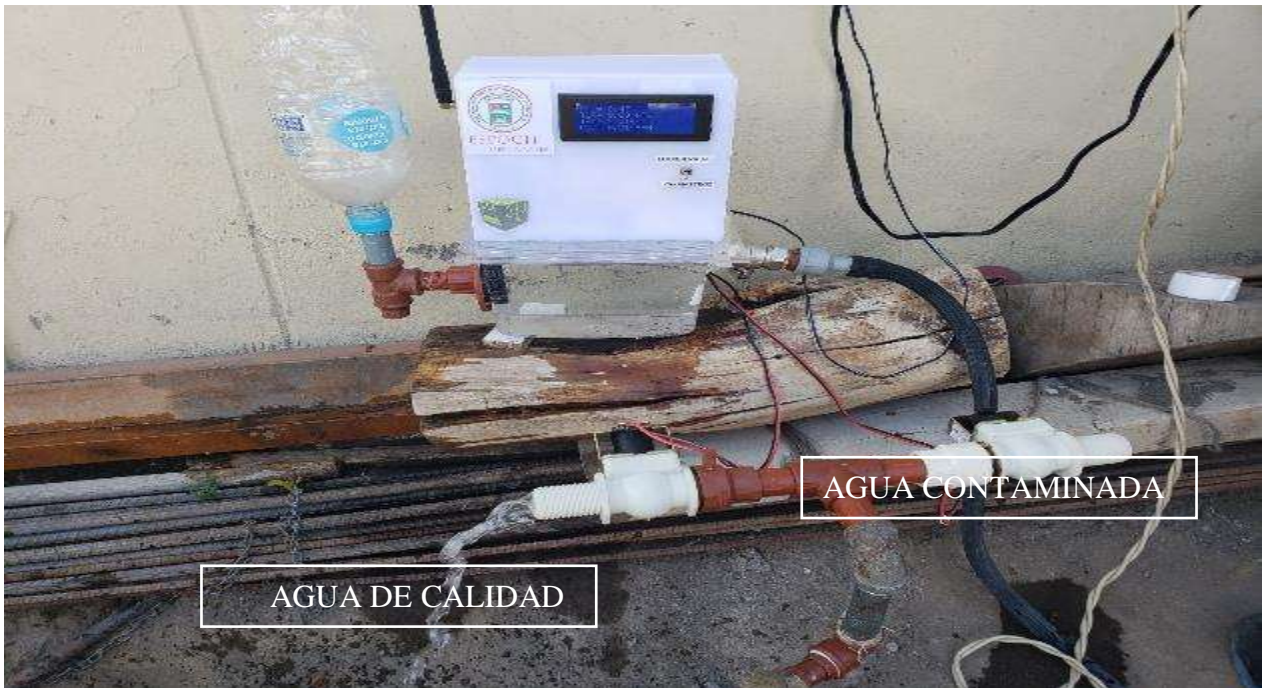
Figura 49-3: Proceso de lectura de muestras de cloro a 0.5 ppm. Realizado por: MUÑOZ, Cristian 2019
