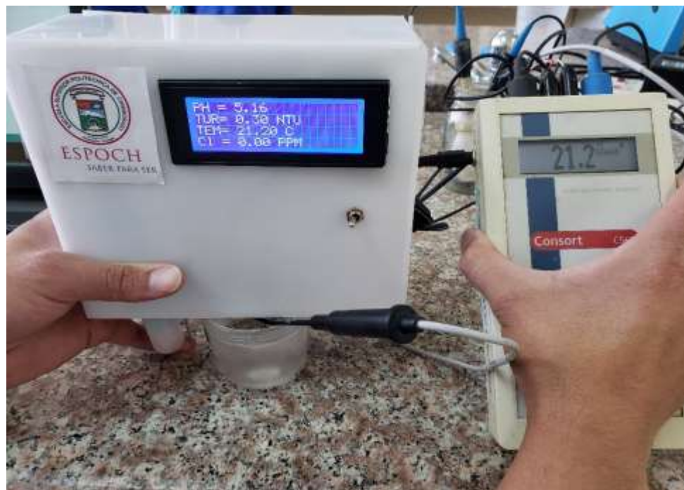
Figura 38-3: Comparación del sensor de temperatura con el equipo patrón
