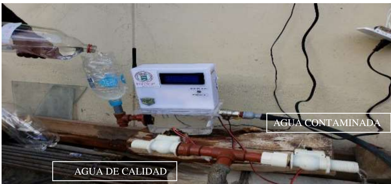
Figura 47-3: Proceso de lectura de muestras de temperatura a 28°C.
