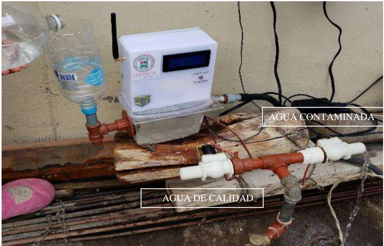
Figura 45-3: Proceso de lectura de muestras de turbidez a 5.5NTU.
