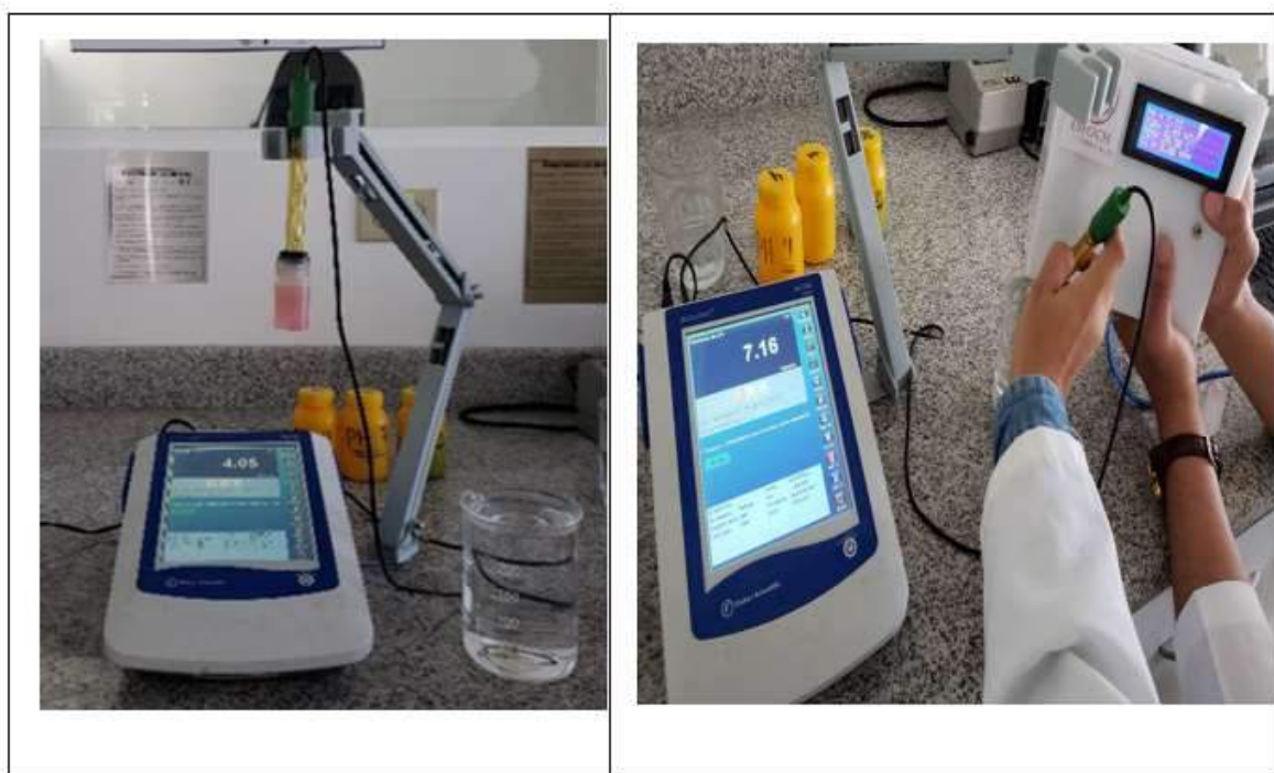
Figura 37-3: Validación del sensor de pH con el equipo patrón.
