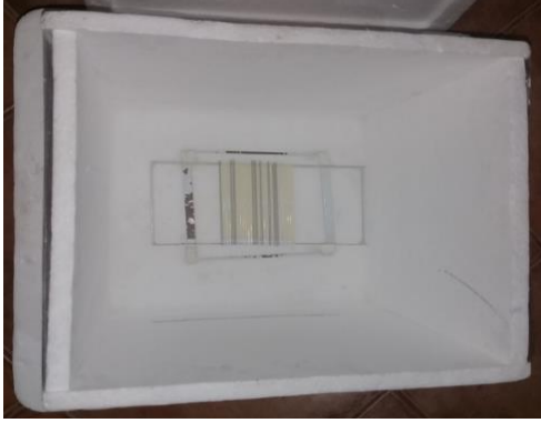
Fotografía 21-2. Proceso de congelación de pajuelas con vapor de nitrógeno.
