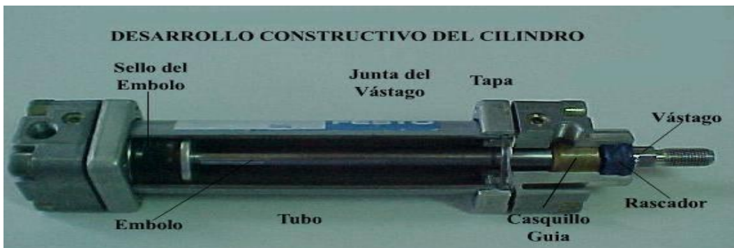
Figura. IV.44. Desarrollo constructivo de un cilindro.
