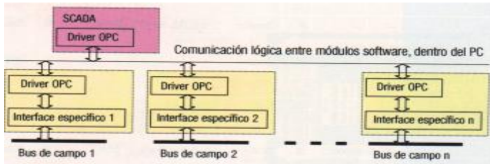
Figura II.27. Drivers OPC de cada fabricante de software SCADA.
