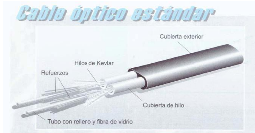
Figura II.9. Fibra óptica de vidrio estándar para aplicaciones industriales.
