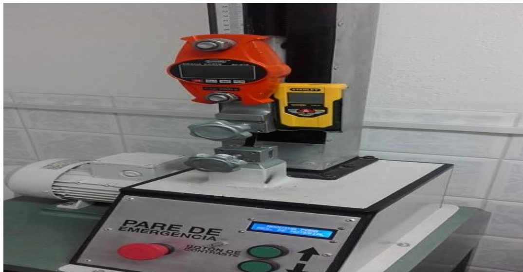
Fotografía 1-2: Partes de un equipo para realizar la medición de la resistencia a la tensión el cuero.
