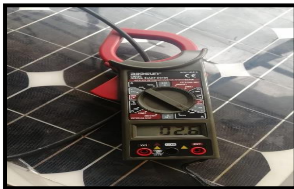
Figura 15-3: Medición del amperaje del panel fotovoltaico en corto circuito.
