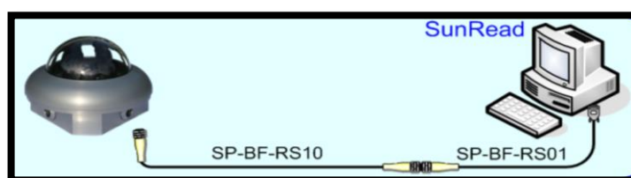
Figura 9-3: Esquema conexión del pirómetro
