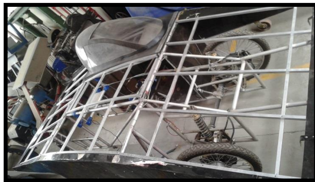
Figura 7-3: Ensamblaje estructura soporte de aluminio.
