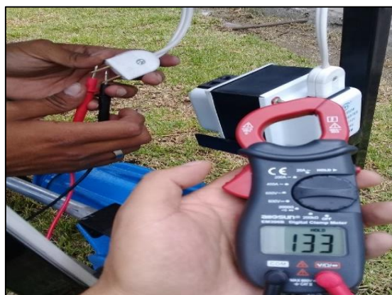
Figura 11-4. Voltaje al ingreso de bobinado
