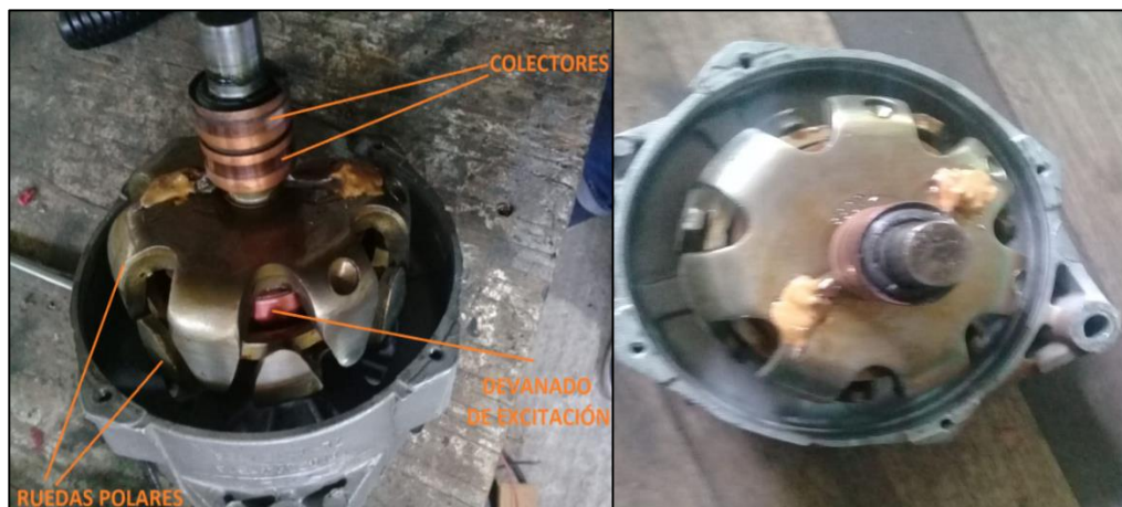
Figura 6-4. Rotor o inductor Chevrolet, devanado de excitación modificado
