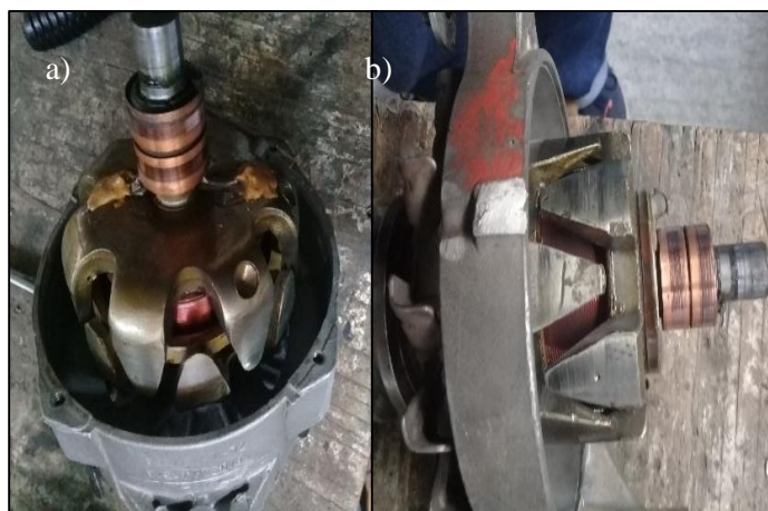
Figura 2-3. Rotor rebobinado: a) Chevrolet b) Ford
