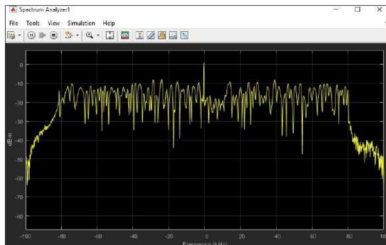
Figura 12-3: Espectro de OFDM receptada a 200m
