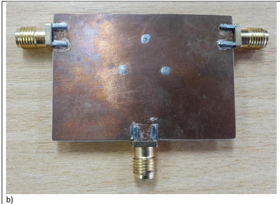
**Figura 45-3:** Implementación de Balun MMIC MTX2-143+ para trabajar de 5.5 a 13.5 GHz. a) Vista frontal b) Vista posterior.
