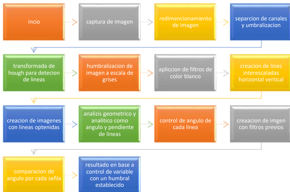
Gráfico 3-2: Detección de líneas laterales y paso cebra
