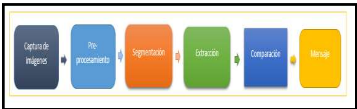
Figura 2-2: Bloques del procesamiento de las imágenes
