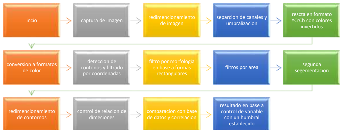
Gráfico 2-2: Detección de próximo a paso lateral, semáforo y paso cebra. Realizado por: Oscar Segura, 2018
