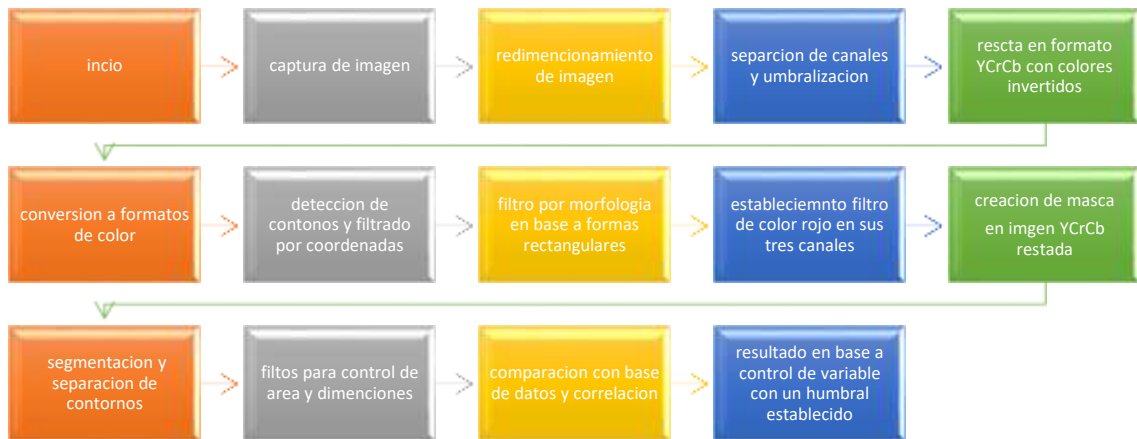
Gráfico 2-2: Detección de pare y semáforos.
