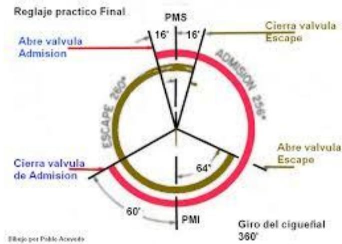
**Figura 2-11:** Sincronización de válvulas motor 4T
