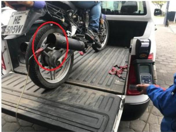
**Figura 4-3:** Prueba de emisiones de gases
