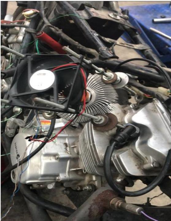
**Figura 3-6:** Sensor de presión acoplado a la motocicleta
