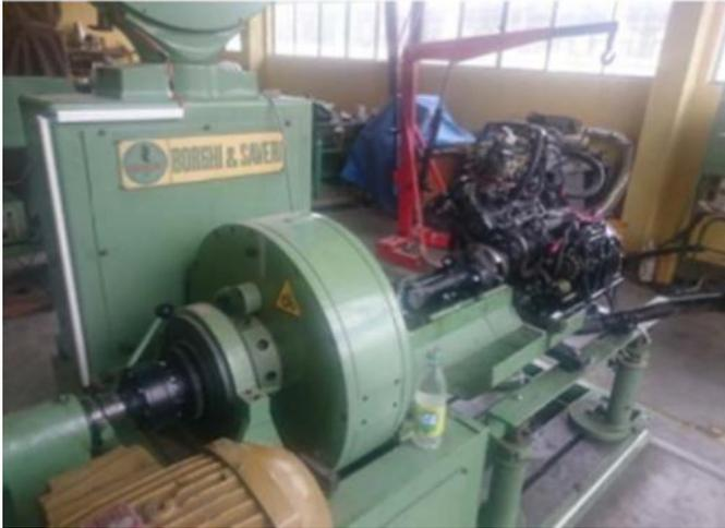
**Figura 2-1:** Motor Yamaha 400 en el banco dinamométrico
