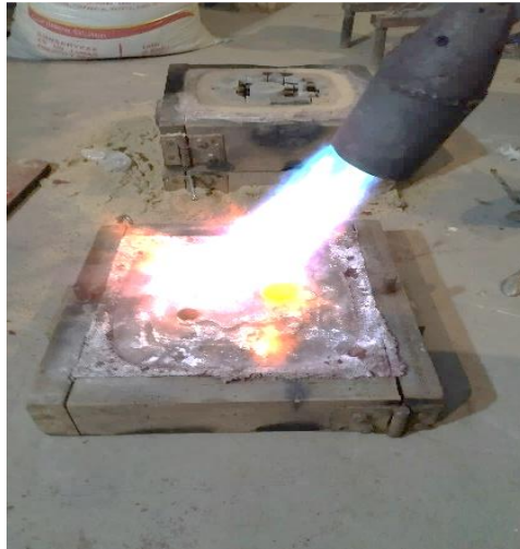
Figura 52-3: Eliminación de la humedad.
