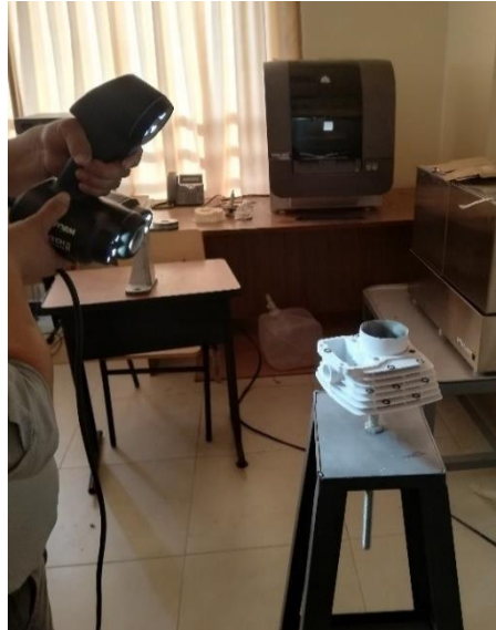
Figura 25-3: Barrido con el Scanner 3D.
