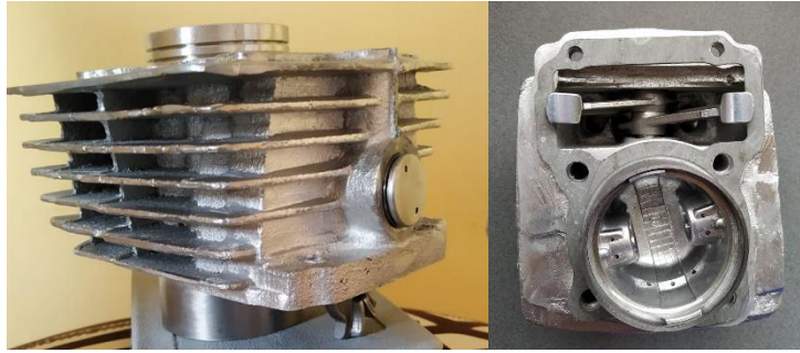
Figura 59-3: Encamisada del cilindro.
