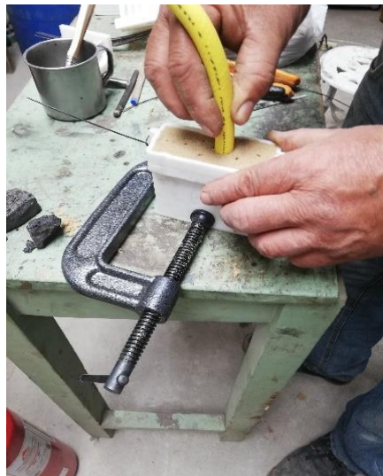
Figura 44-3: Aplicación del dióxido de carbono (CO 2 ).
