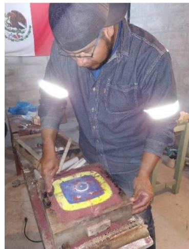
Figura 49-3: Eliminación de la arena sobrante
