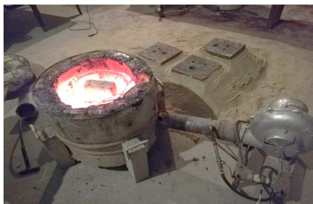
Figura 54-3: vertido del lingote en el horno de crisol.
