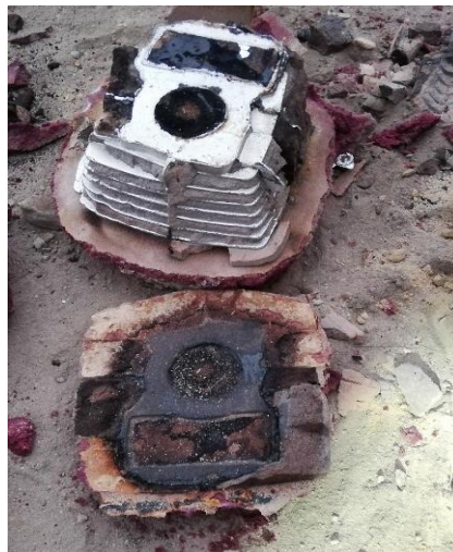
Figura 56-3: Remoción del molde de arena.
