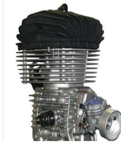
Figura 6-2: Refrigeración por aire.
