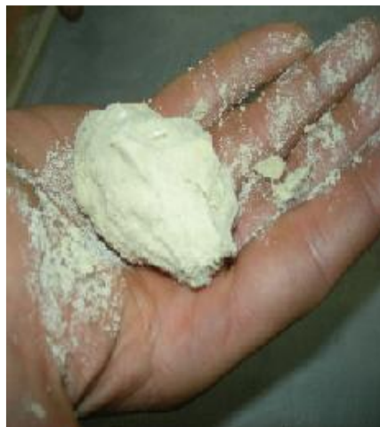
Figura 38-3: Prueba de humedad.
