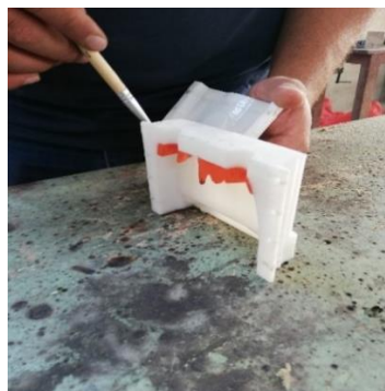
Figura 42-3: Colocación del desmoldante.
