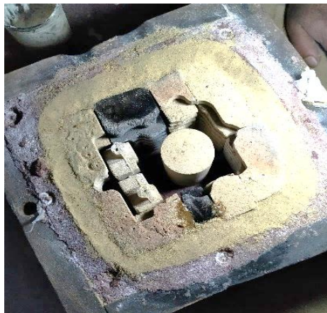
Figura 51-3: Compactación del molde, para formar un el bloque.
