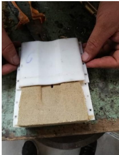
Figura 45-3: Desmolde de la galleta.
