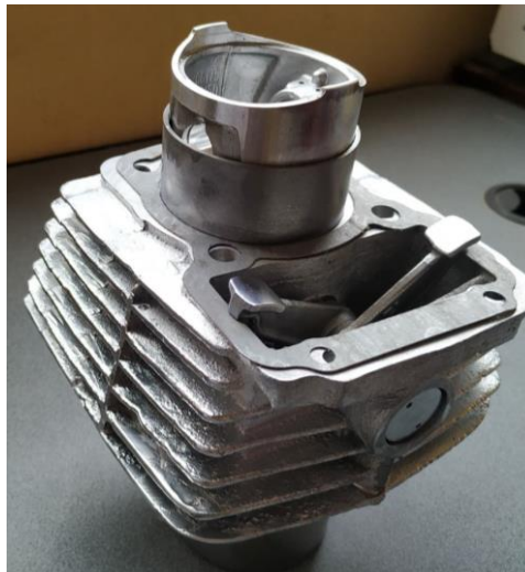
Figura 60-3: Encamisada y colocación del pistón
