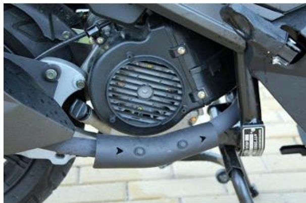
Figura 7-2: Refrigeración por aire forzado.
