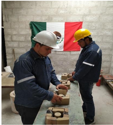
Figura 47-3: Agrupación de las galletas para formar el molde.
