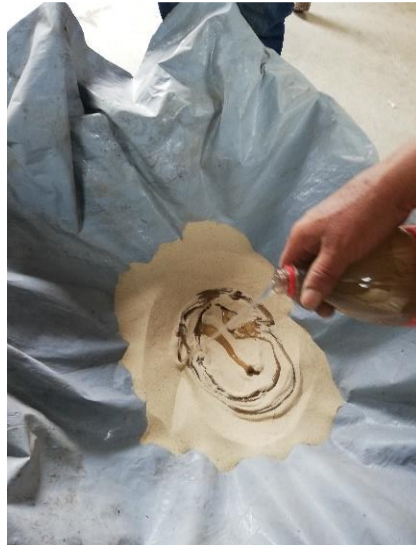
Figura 39-3: Colocación del aglutinante
