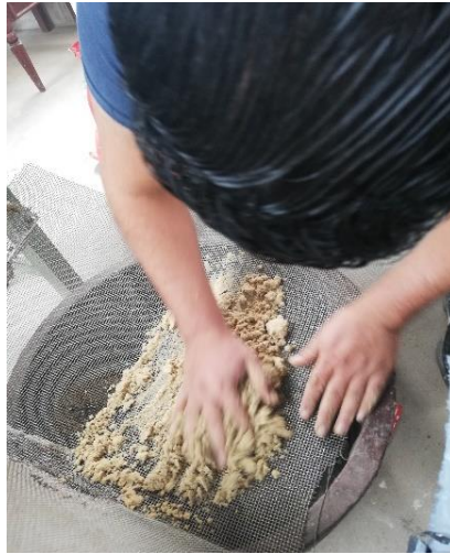
Figura 41-3: Tamizado de la arena con el aglutinante.
