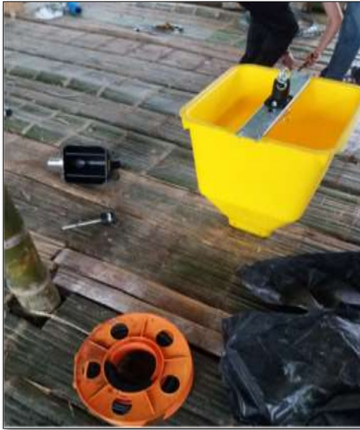
Anexo O: Ajuste de piezas de la tolva y fijación del tornillo sin al eje del motor.
