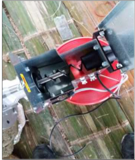
Anexo O: Ajuste de piezas de la tolva y fijación del tornillo sin al eje del motor.
