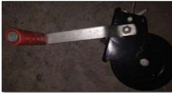
Figura 25-2: Sistema de regulación de la altura de los comederos
