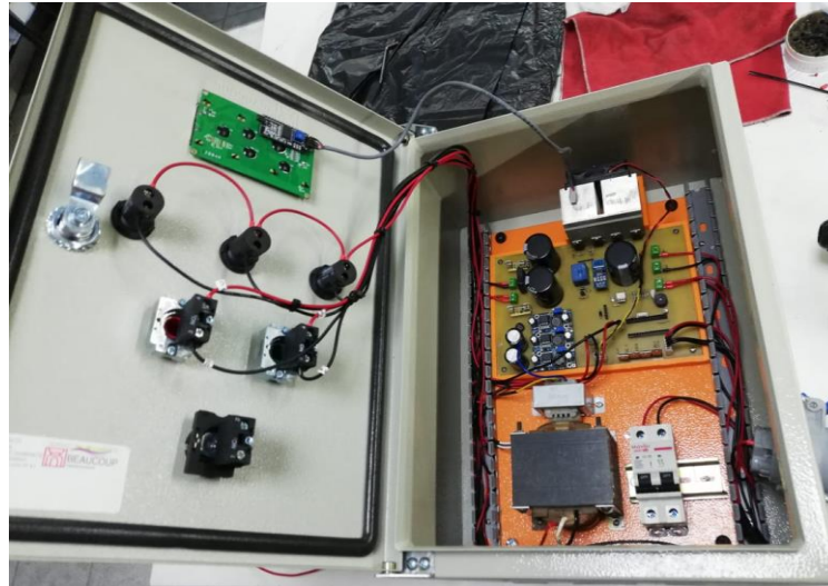
Figura 29-3. Circuito del cargador de baterías híbrido dentro del armario eléctrico
