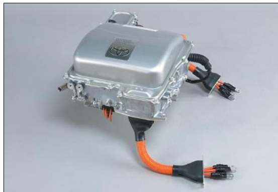
Figura 7-2. Unidad de control de potencia
