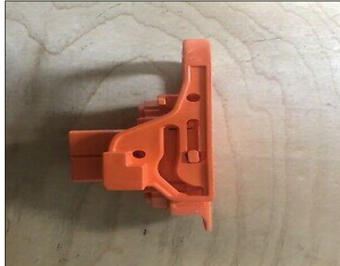
Figura 28-2. Interruptor de la batería del sistema híbrido
