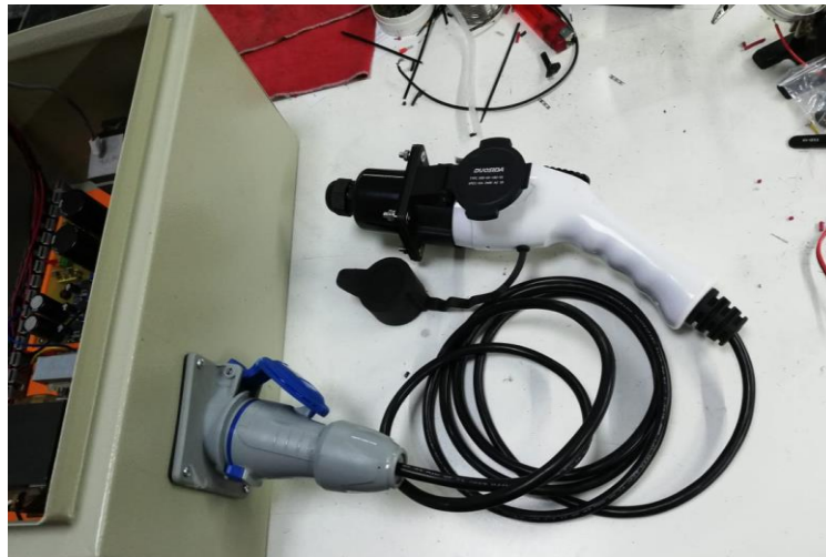
Figura 30-3. Conectores externos del cargador de baterías
