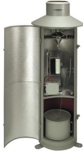
Figura 18-4: Pluviógrafo Propuesto Fuente: Propia
