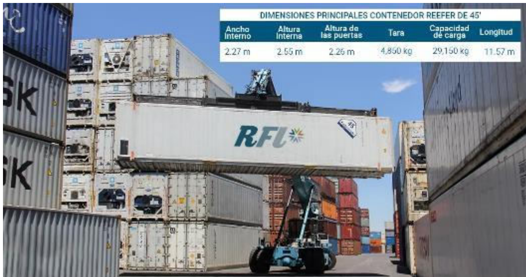
Ilustración 17-2: Dimensiones de un contenedor refrigerado de 45' Fuente: (RFLcargo, 2019)
