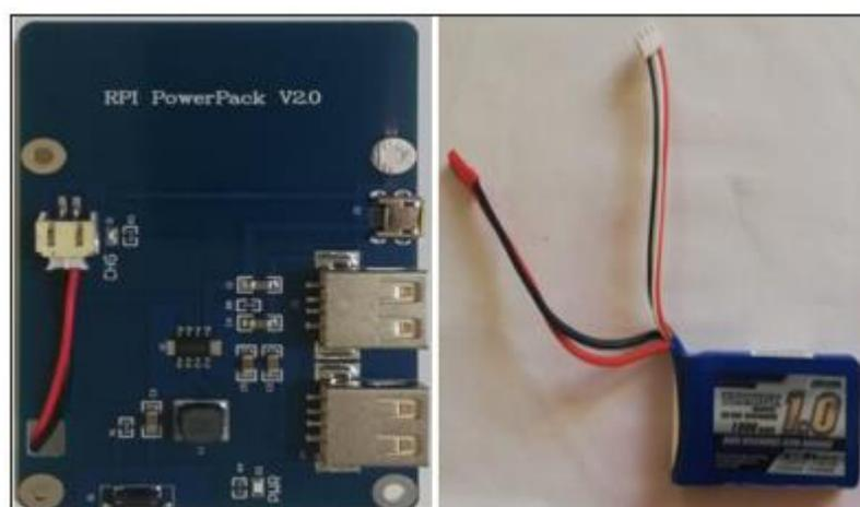
**Figura 19-2:** a) RPI PowerPack V2.0 b) Batería Lipo Turnigy 2S
