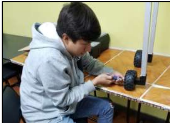
Figura 32-2 Tesista uniendo los motores a los acoples y neumáticos
