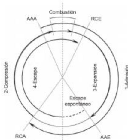
**Figura 4-2:** Diagrama de distribución de un motor de 4 tiempos
