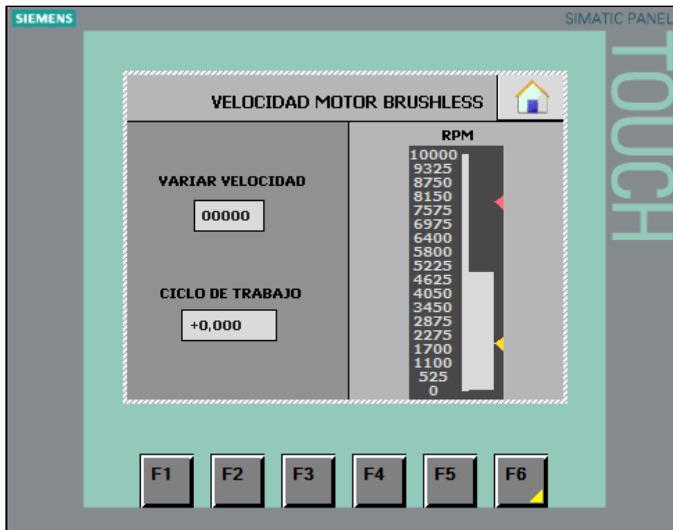
Figura 44-3. Imagen para control del motor brushless desde Touch panel Fuente: Sebastián Vaca, 2019
