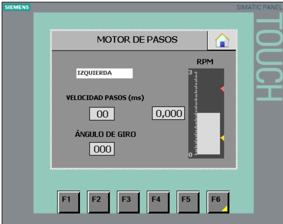
Figura 42-3. Imagen control del motor de pasos desde Touch panel Fuente: Sebastián Vaca, 2019.
