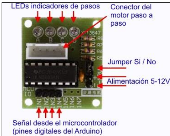
Figura 4-2. Descripción controlador ULN 2003. Fuente: (Robots Didácticos, 2019)
