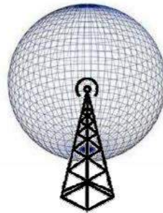
Figura 11-1: Representación de una antena isotrópica
