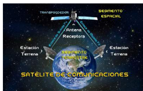
Figura 2: Enlace satelital entre dos estaciones terrestres.
