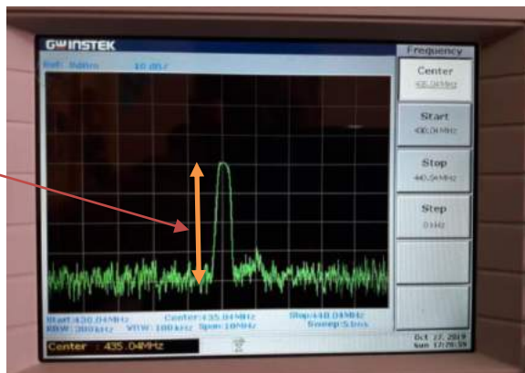
Figura 14-3: Espectro de frecuencia a 435.040 MHz con amplificador
