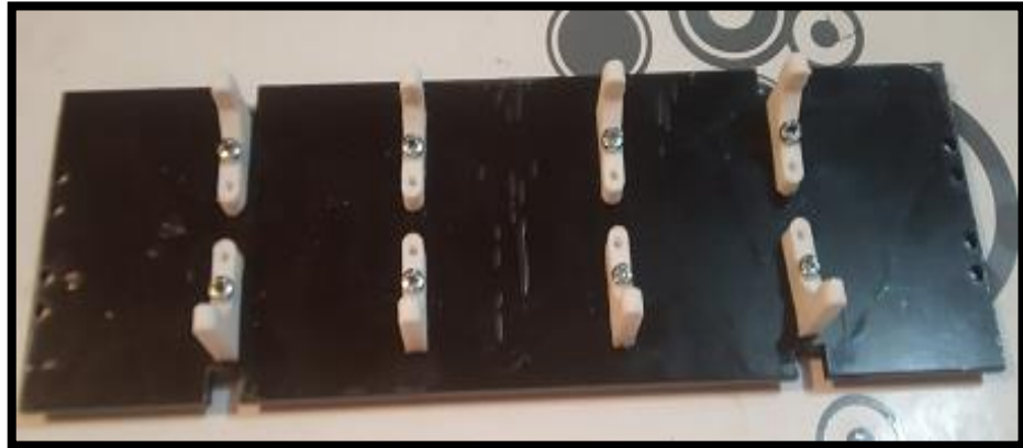
Figura 26-2: Base 1, Ensamblada con los seguros de los motores.
