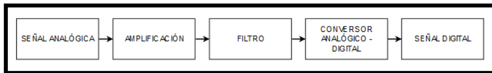
Figura 9-2. Diagrama para digitalizar una señal analógica. Realizado por: Sacaquirin Alexander, 2019.
