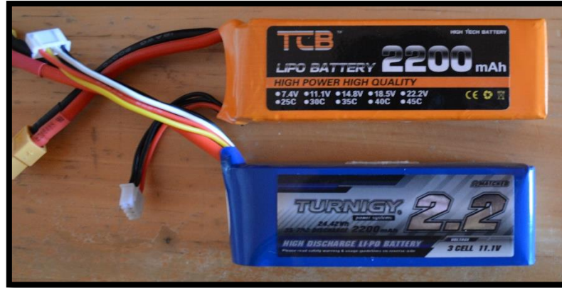
Figura 14-2: Batería Lipo marca Turnigy recargables de 11.1 V a 2200 mAh.
