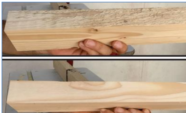
Figura 23-3. Proceso de canteado
