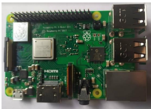
Figura 6-2: Raspberry 3 modelo B+. Realizado por: Talla, David; 2019.
