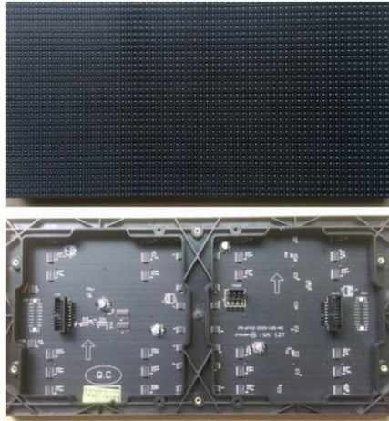
Figura 5-2: Parte delantera y posterior de la matriz LED RGB.
