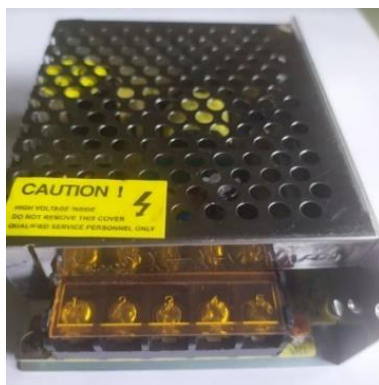
Figura 7-2: Fuente de alimentación conmutada 5V, 12A.
