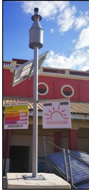
Figura 9-1: Sensor UV. Fuente: (Geomovil, 2018)
