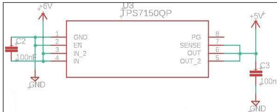
Figura 12- ¡Error! Utilice la pestaña Inicio para aplicar Título 1; Título de Primer Nivel al texto que desea que aparezca aquí.: Diagrama esquemático de la conexión del regulador de 5V para alimentación del microcontrolador.
