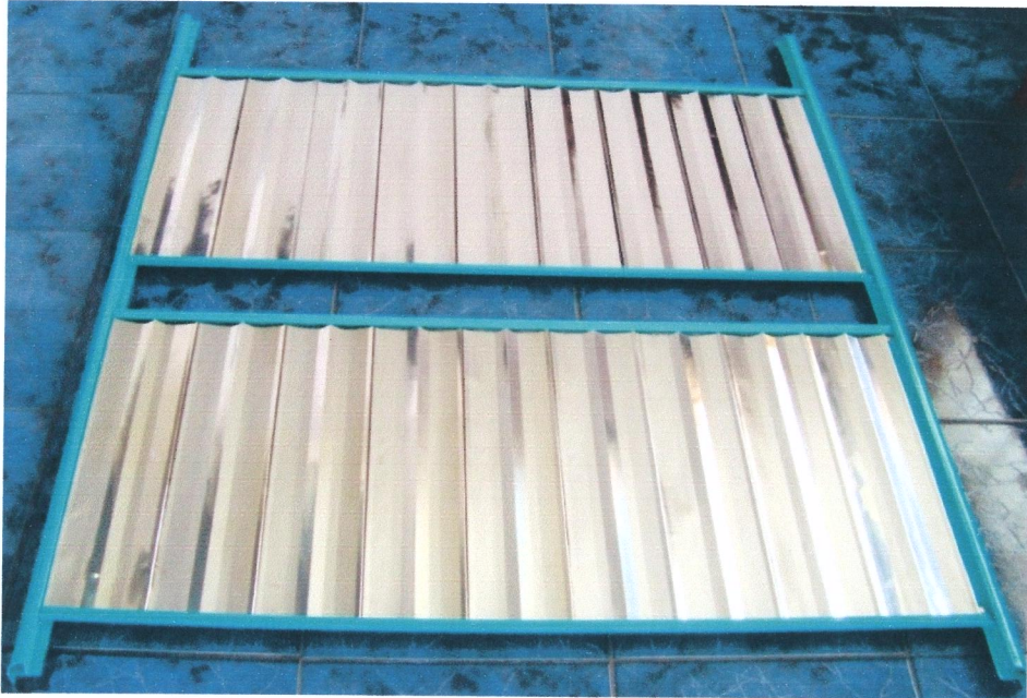
Fig. 5.1: Estructura soporte y placas reflectoras
