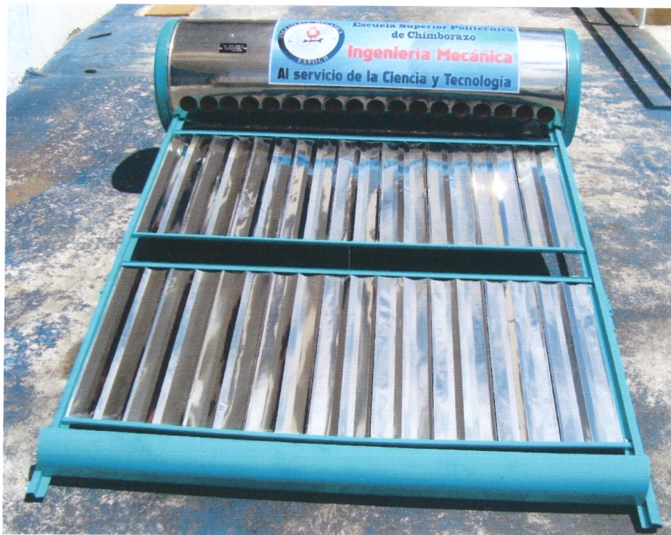
Fig. 5.2: Estructura soporte en conjunto con el reservorio
