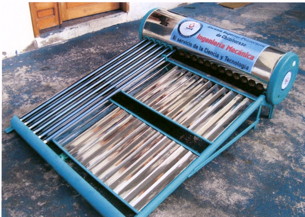
Fig. 5.4: Colocación de los tubos de borosilicato en el equipo
