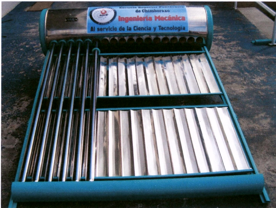
Fig. 5.3: Estructura, reservorio, y tubos al vacío con sus respectivos empaques
