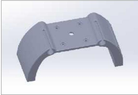
**Figura 16-2.** Extremo y base de motor.
