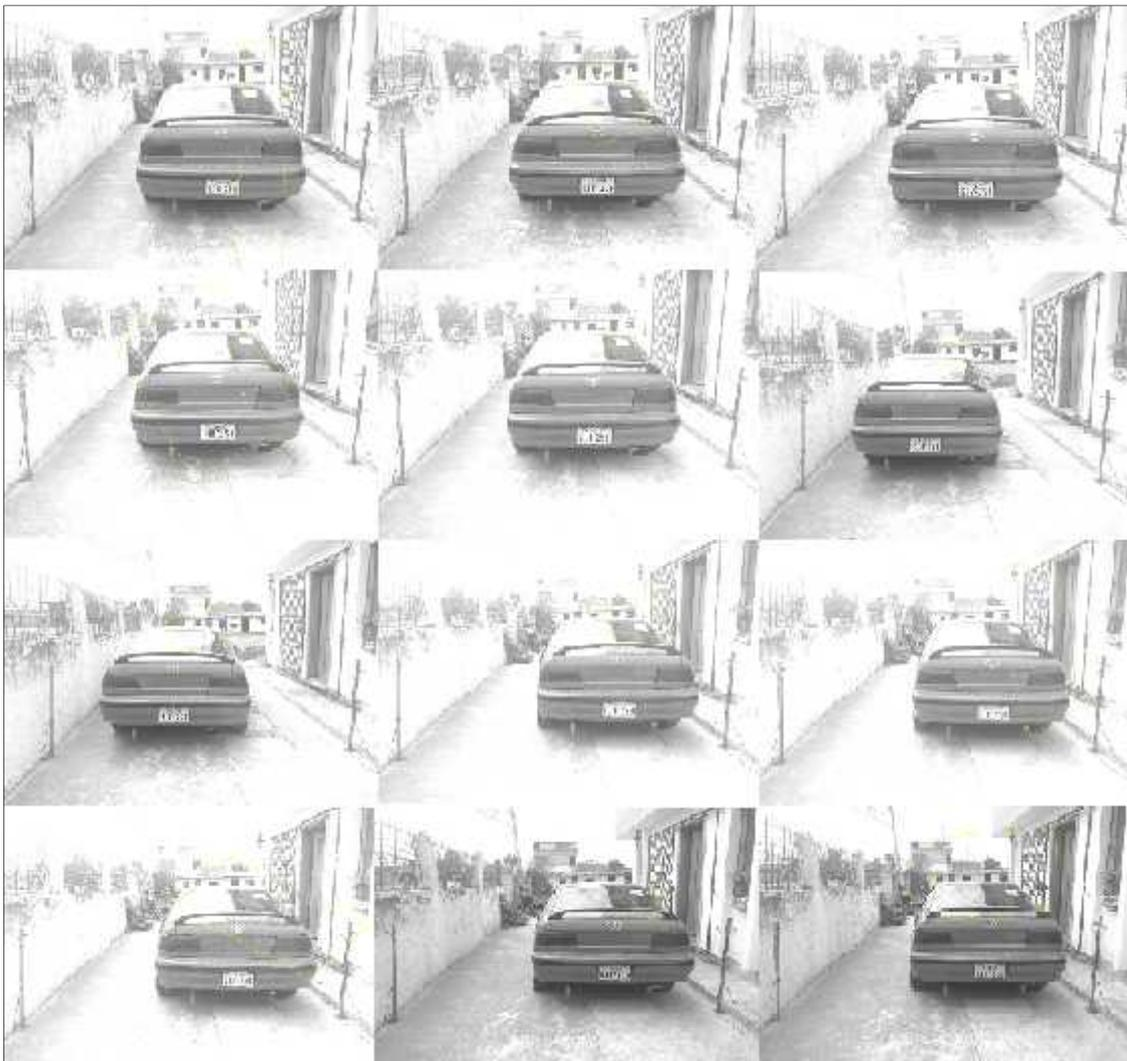
**Figura 4-3.** Pruebas de vehículo en reversa para detección de logotipo en ambiente soleado.
