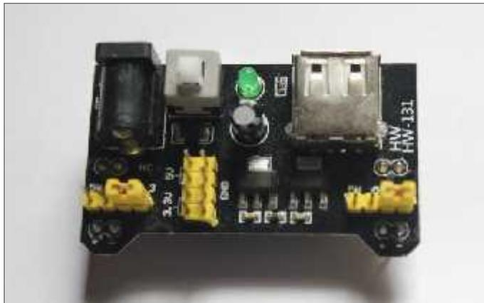
**Figura 3-2.** Fuente de alimentación MB-V2.
