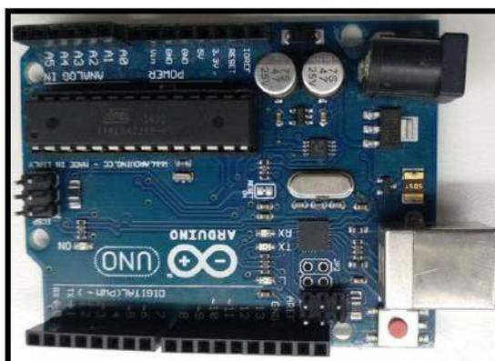
**Figura 3-2:** Microprocesador Arduino UNO.
