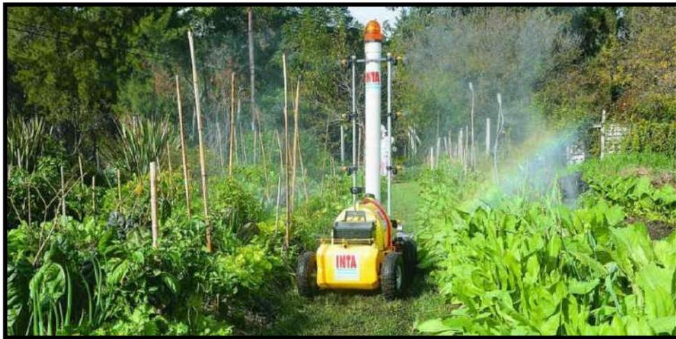
**Figura 2-1:**Robot fumigador TRAKÜR
