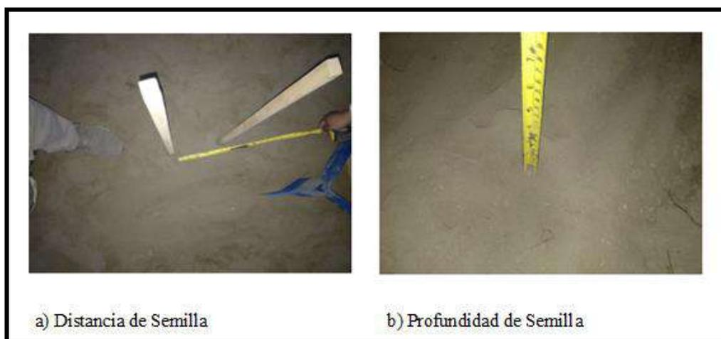
**Figura 10-3:** Distancia y Profundidad del Prototipo AGSEM.
