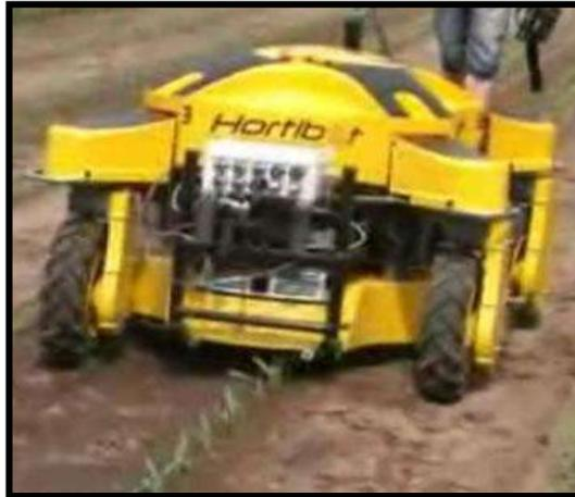
**Figura 3-1:** Robot eliminador de malezas Hortibot
