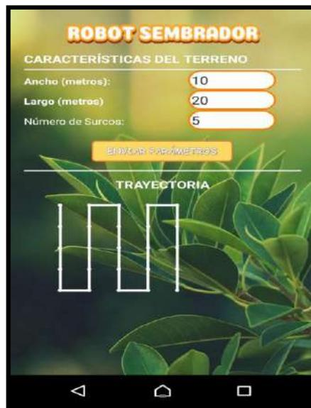
**Figura 6-3:** Pantalla de Configuración de la Aplicación Móvil.
