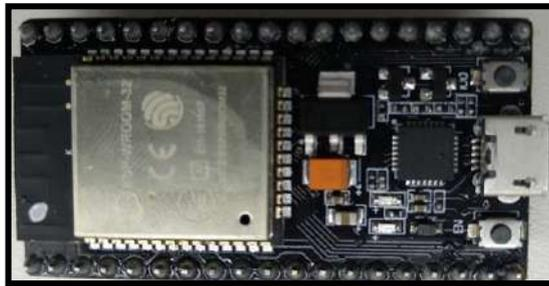
**Figura 4-2:** Microprocesador NodeMCU
