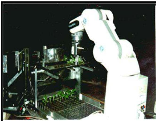
**Figura 1-1:** Robot recogedor de crisantemos
