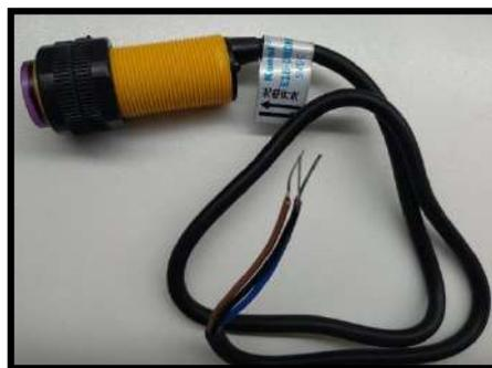
**Figura 6-2:** Sensor Fotoeléctrico Infrarrojo
