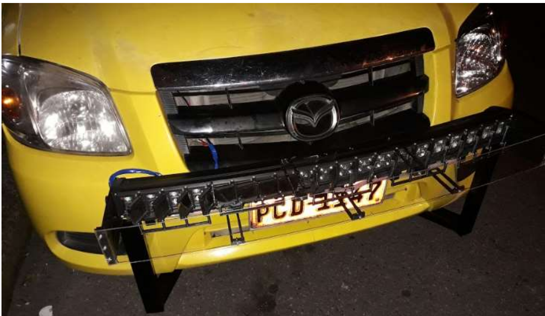
Figura 6-3: Montaje de la barra LED en el vehículo Realizado por: Coyago, Jhinson & Coyago, Jonathan. 2019
