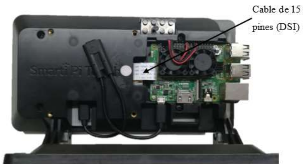
Figura 28-2: Montaje Final Raspberry Pi 3B + Pantalla LCD 7" Realizado por: Coyago, Jhinson & Coyago, Jonathan. 2019
