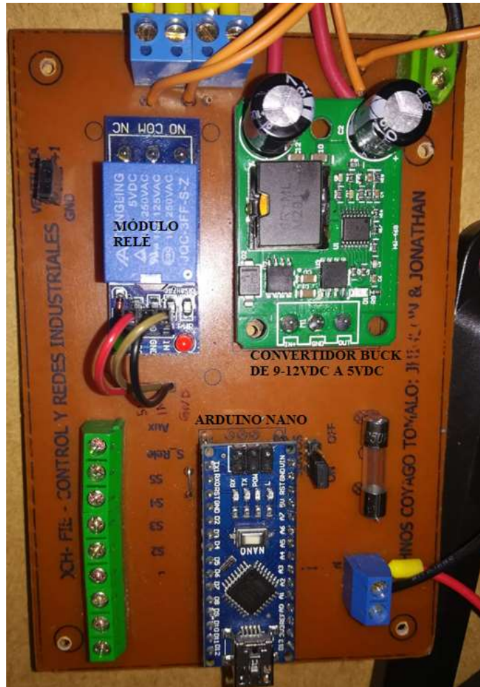
Figura 61-2: Colocación de los elementos en la placa Realizado por: Coyago, Jhinson & Coyago, Jonathan. 2019
