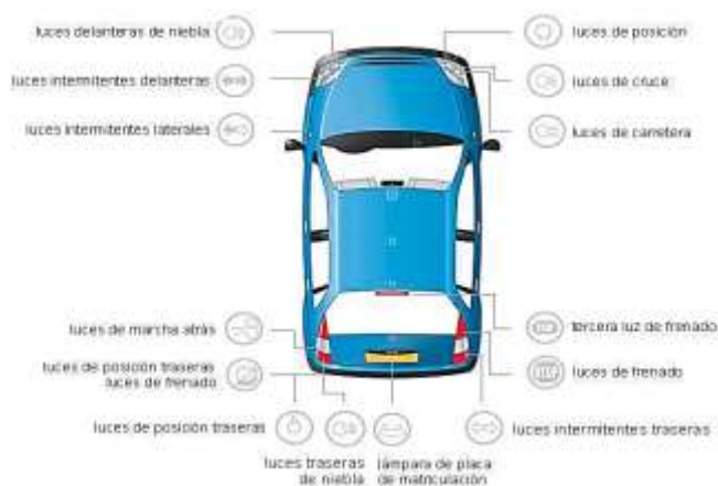
Figura 1-1: Sistema de Iluminación en el vehículo
