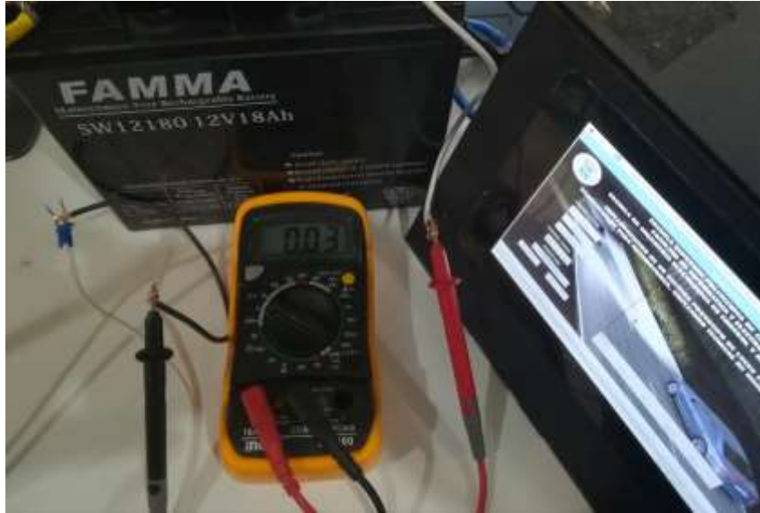
Figura 4-3: Medición de corriente en la Fuente DC Realizado por: Coyago, Jhinson & Coyago, Jonathan. 2019
