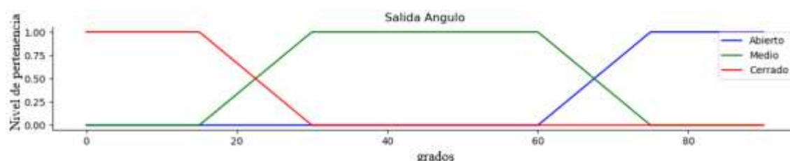
Figura 46-2: Representación de la función de membresía en la salida
