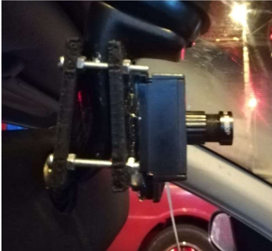
Figura 60-2: Fijación de la cámara en el retrovisor Realizado por: Coyago, Jhinson & Coyago, Jonathan. 2019
