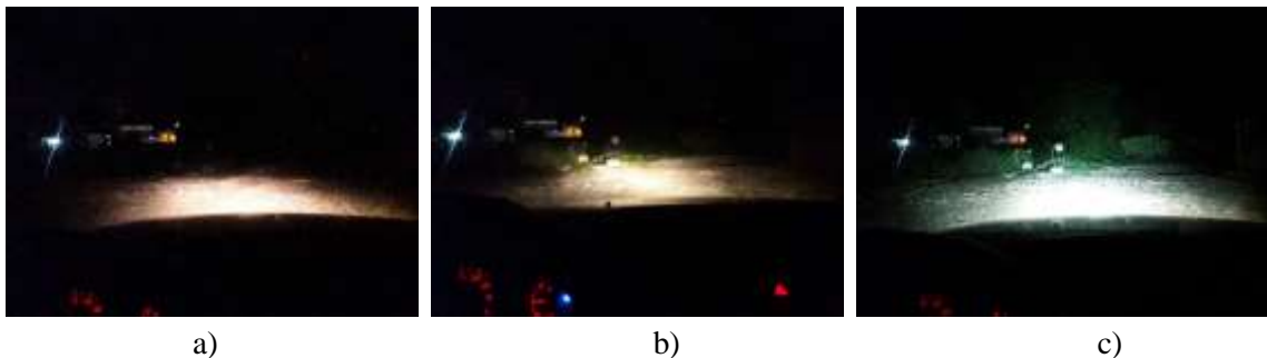
Figura 8-3: Iluminación del entorno. a) luces bajas, b) luces altas, c) barra LED sin cambios Realizado por: Coyago, Jhinson & Coyago, Jonathan. 2019
