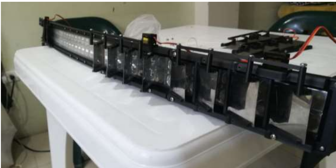
Figura 57-2: Ensamble del mecanismo en le barra LED Realizado por: Coyago, Jhinson & Coyago, Jonathan. 2019
