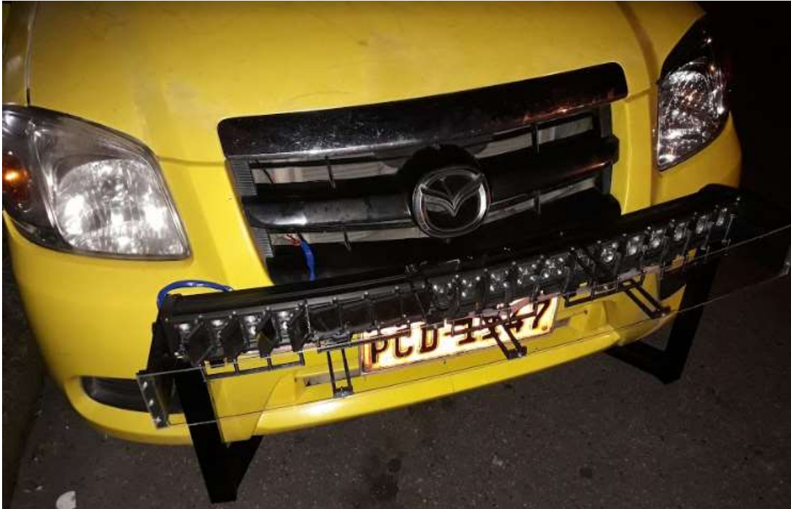
Figura 64-2: Montaje de la barra LED Realizado por: Coyago, Jhinson & Coyago, Jonathan. 2019
