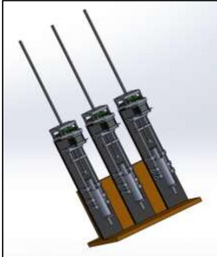
**Figura 7-1:** Pistón para extrusión
