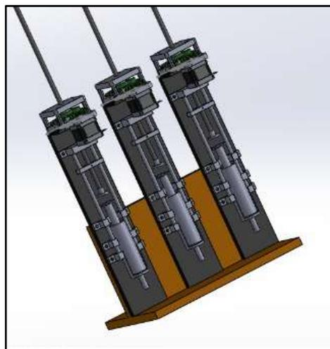
**Figura 4-1:** Cabezal y boquilla de extrusión
