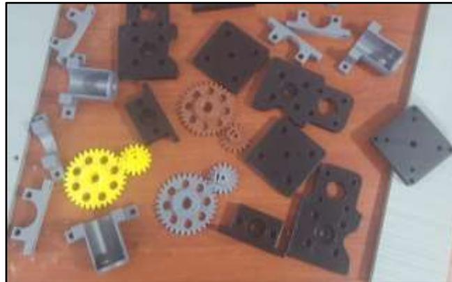
**Figura 4-2:** Materiales impresos en 3D, en plástico PLA
