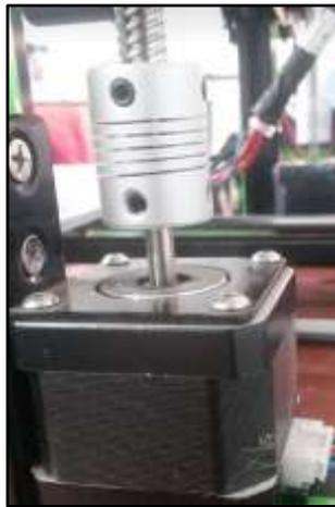
**Figura 10-2:** Acoplamiento
