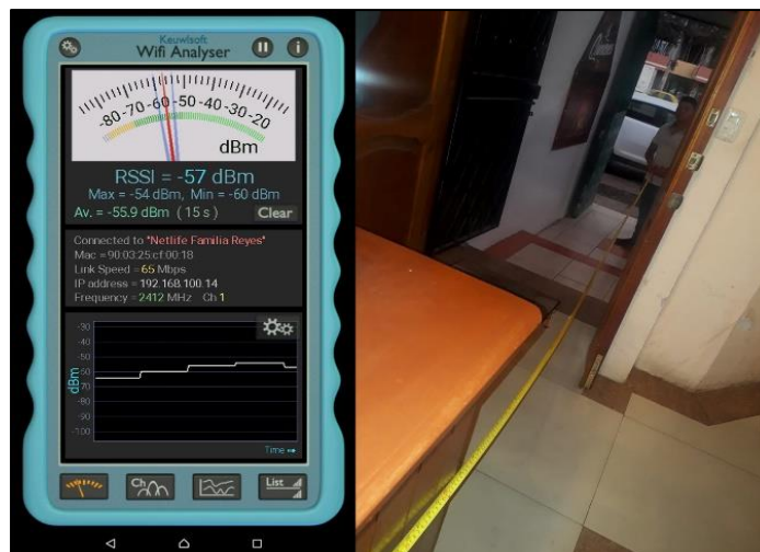
Figura 11-3: Evidencia de medición de intensidad de señal
