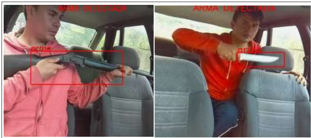
Figura 8-3. Detección positiva de escopeta y cuchillo en ambiente de automóvil
