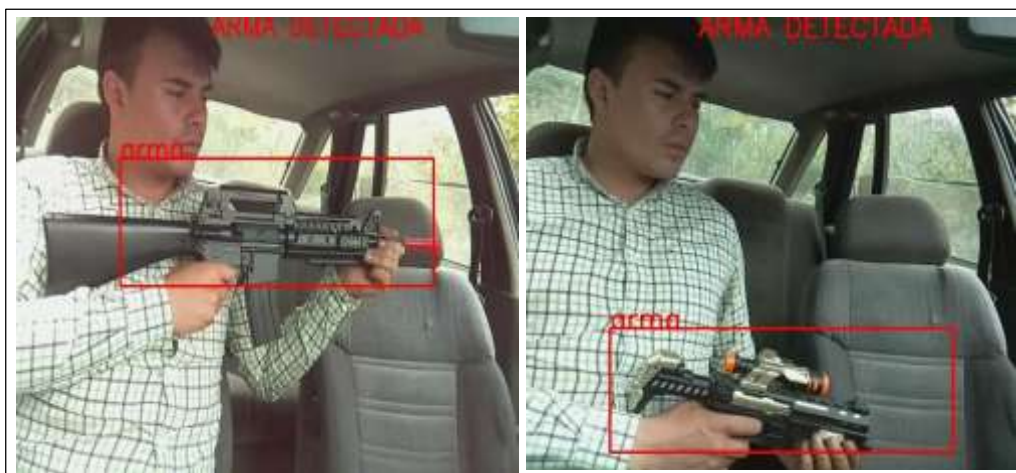
Figura 6-3. Detección positiva de metralleta y recortada en ambiente de automóvil
