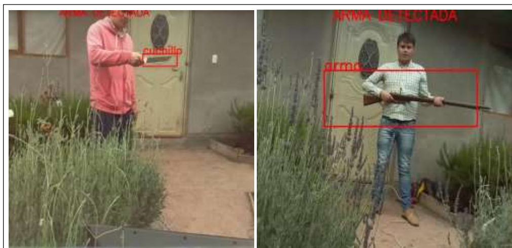
Figura 12-3. Detección positiva de cuchillo y escopeta en ambiente de parque
