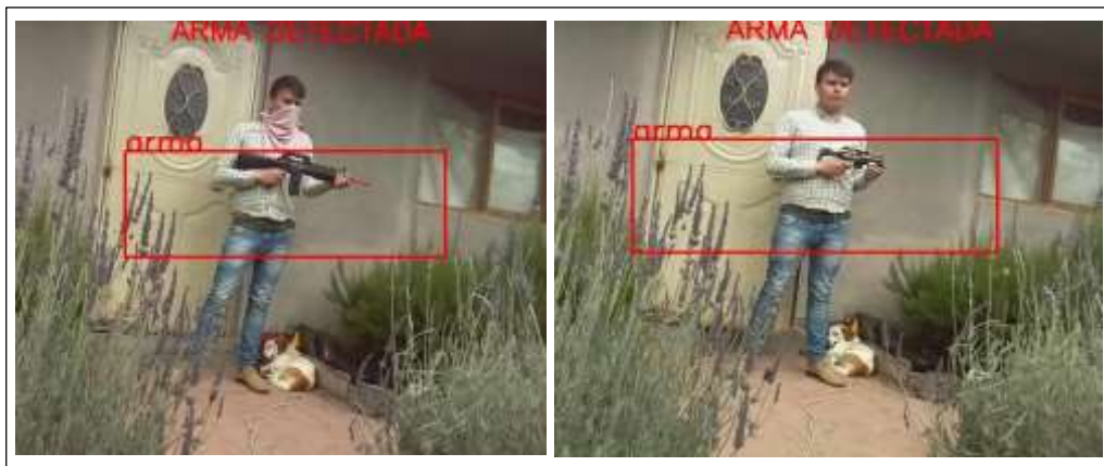
Figura 11-3. Detección positiva de metralleta y recortada en ambiente de parque
