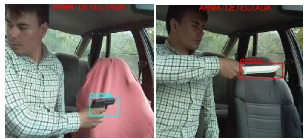
Figura 7-3. Detección positiva de pistola y cuchillo en ambiente de automóvil
