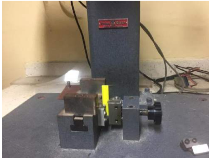
Figura 17-3: Ensayo de impacto IZOD bajo la Norma ASTM D 256
