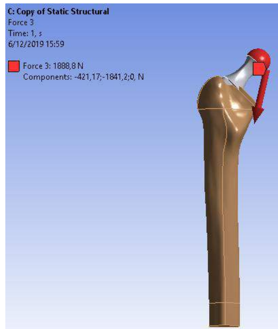
Figura 14-4: Aplicación de las fuerzas caso fuerza externa de 6kg
