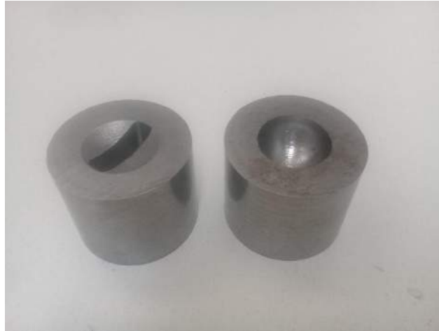
Figura 60-4: Probetas de Acero AISI 1018 ensayo compresión
