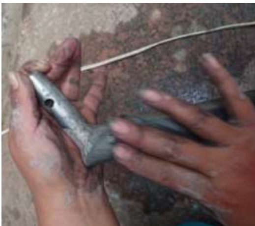
Figura 50-3. Lijado del exceso de masilla.
