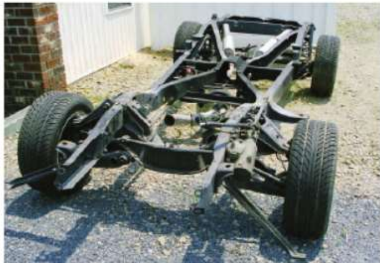
Figura 2-2. Chasis con mecánica. Fuente: Montes Ortega & Montes Ortega, 2012.
