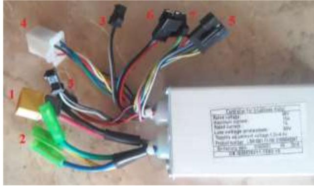
**Figura 12-3.** Función de cables de controlador.
