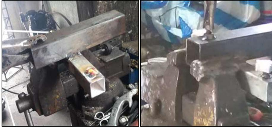
**Figura 22-3.** Soldadura de tuercas en la base de sujeción.
