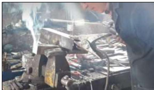
**Figura 21-3.** Soldadura de la base de sujeción.
