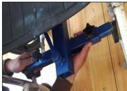
**Figura 46-3.** Instalación de base de sujeción.
