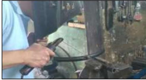
**Figura 26-3.** Soldadura de la base del acople central.
