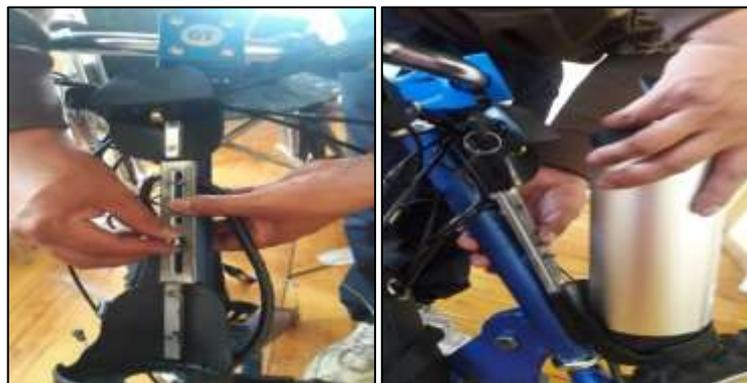
**Figura 43-3.** Instalación de la base y la batería.
