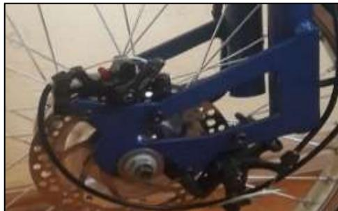
**Figura 36-3.** Implementación del sistema de freno.
