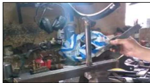
**Figura 27-3.** Soldadura la base al acople central.
