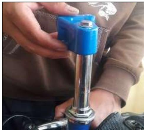
**Figura 38-3.** Instalación de la espiga de dirección.
