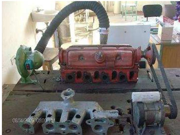
*Figura 6: Banco de pruebas medir flujo de aire en el múltiple de admisión.*
