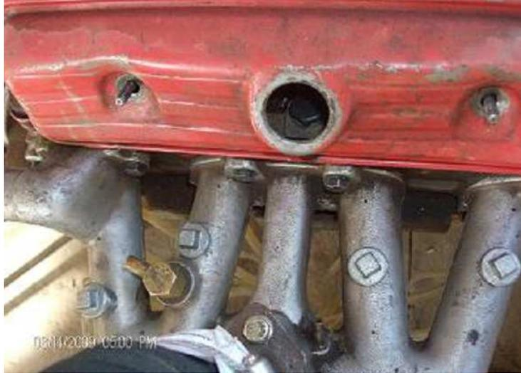
**b. Orificios con sus respectivas mangueras para toma de datos presión.**
