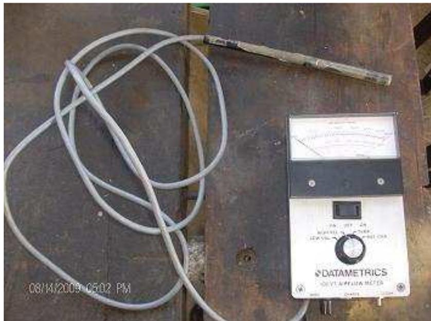
**Figura 7:** Medidor de velocidad (Datametric)
