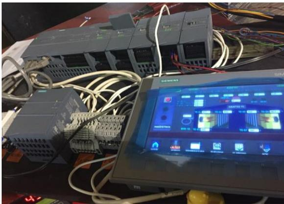
**Figura 1-4.** Disposición del PLC implementado
