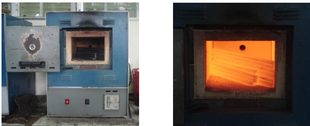
Figura 3.5: Secciones de 35cm y 25cm de longitud de varillas corrugadas, ubicadas dentro del horno eléctrico.
