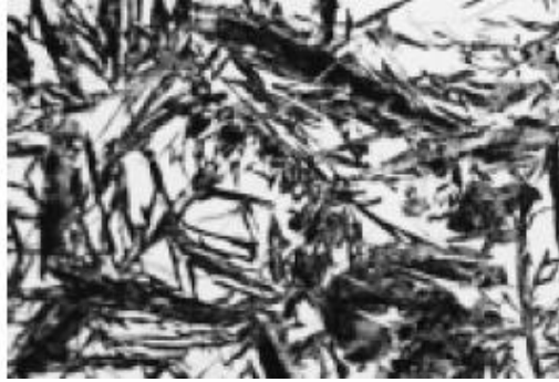
Figura 2.32: Fotomicrografía de un acero con microestructura martensítica. Los granos en forma de aguja son el constituyente martensita y las regiones blancas son austenita retenida; no se ha transformado durante el temple rápido. 1220 x [10].
