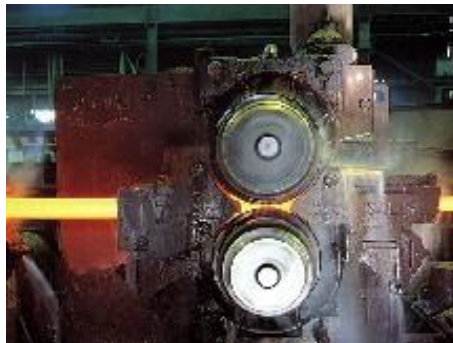
Figura 2.4: Trenes de laminación en Caliente [7]
