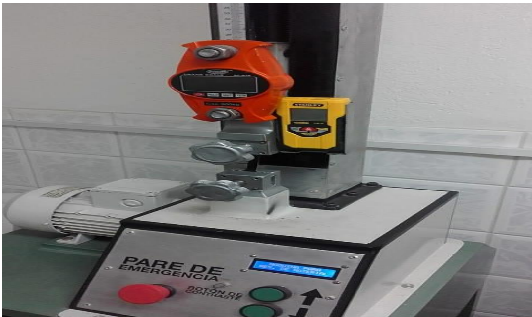
Fotografía 1-3: Partes del equipo para realizar la medición de la resistencia a la tensión el cuero.
